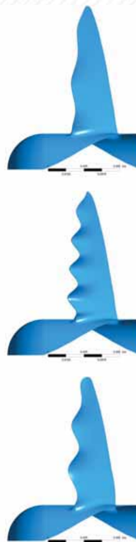
Рис. 2. Геометрии различных волнистых кромок гребных винтов, подлежавших расчету
