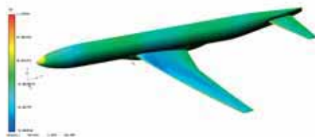
Рис. 6. Распределение коэффициента давления по поверхности модели. Вид сверху
