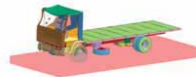
Рис. 3. Пример моделирования подрыва 10-тонного грузовика
