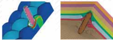
Рис. 5. Примеры моделирования взаимодействия броневой пули с различными типами преград
