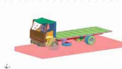
Рис. 3. Пример моделирования подрыва 10-тонного грузовика
