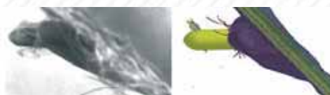
Рис. 2. Пробивание 20-слойного тканого пакета из арамидных волокон (виртуальный и натуральный эксперименты)
