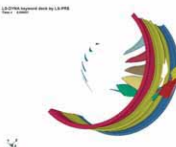
Рис. 4. Пробивание корпуса двигателя при обрыве лопатки
