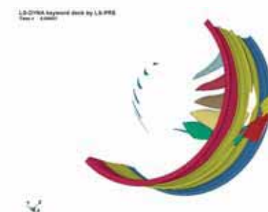
Рис. 4. Пробивание корпуса двигателя при обрыве лопатки
