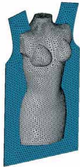
Рис. 1. Модели трикотажного изделия и тела женщины. Сетка конечных элементов
