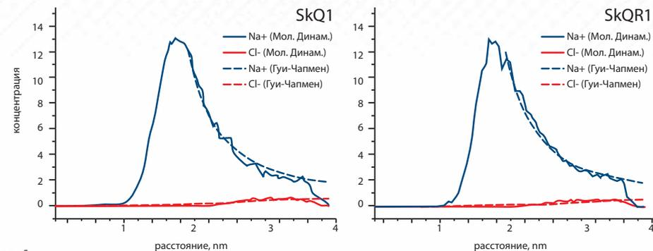
**Рис. 4.** Распределение катионов натрия и анионов хлора (синие и красные линии) вблизи поверхности мембраны. Концентрация ионов, рассчитанная по классической теории Гуи-Чапмена, изображена пунктирными линиями
