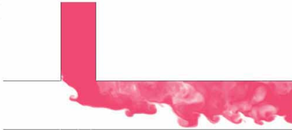
Рис. 3. Изообласти температуры при турбулентном смешении двух жидкостей в тройнике (красный цвет – более горячая жидкость)
