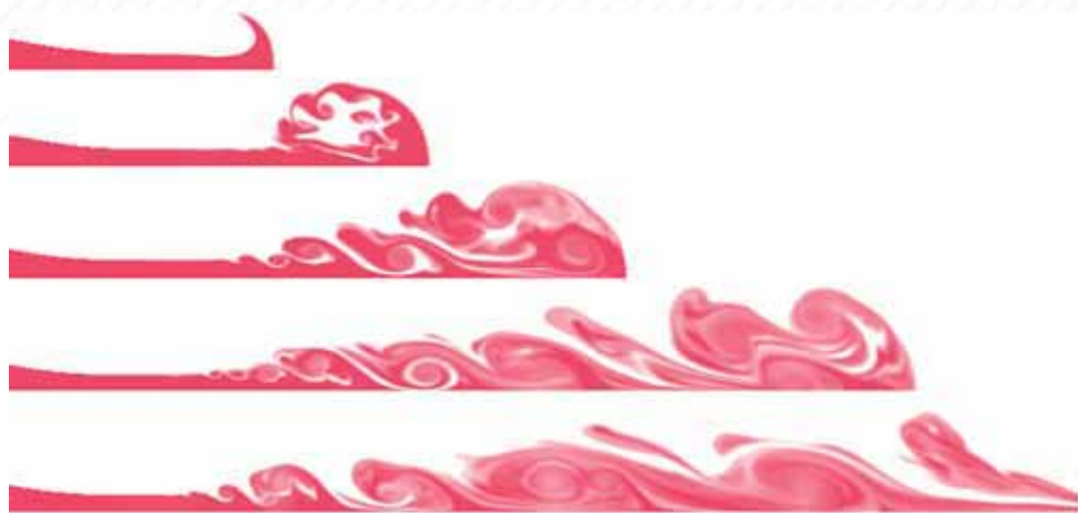
Рис. 6. Изообласти температуры в задаче нестационарного истечения нагретой струи
