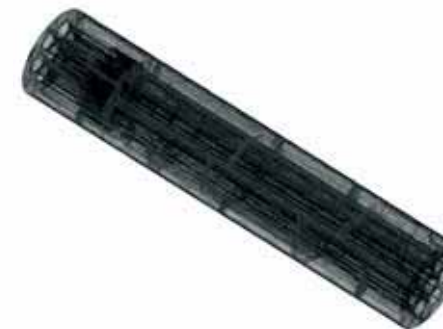
Рис. 2. Сетка фрагмента тепловыделяющей сборки со спейсером (светлые линии – области декомпозиции по алгоритму metis)
