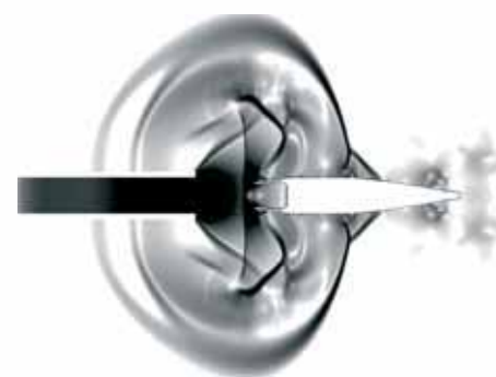
Рис. 3. Распределения градиента давления газа, момент времени 45,8 мс
