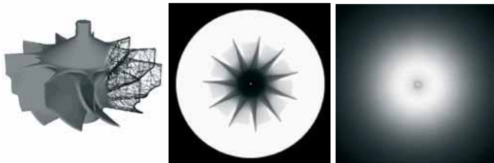
Рис. 1. Объект (слева); поток нерассеянных фотонов после прохождения объекта (в центре); поток рассеянных фотонов (справа)
