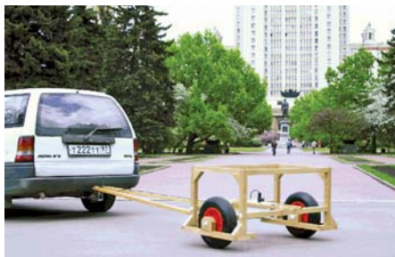
Рис. 3. Экспериментальный мобильный комплекс для зондирования дорог
